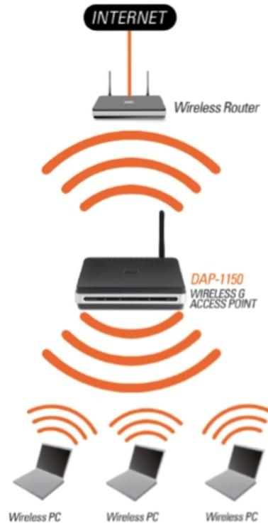
Расширение радиуса действия беспроводного маршрутизатора с помощью использования точки доступа DAP-1150
