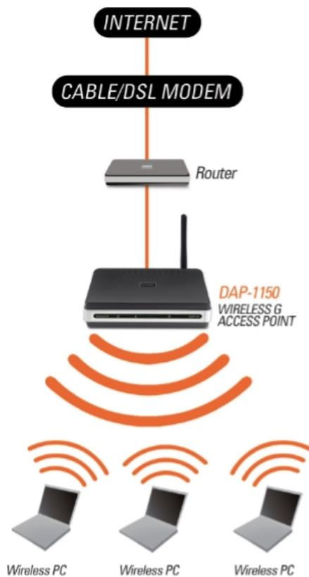
Беспроводные компьютеры подключаются к сети, используя DAP-1150 в качестве центральной точки подключения
