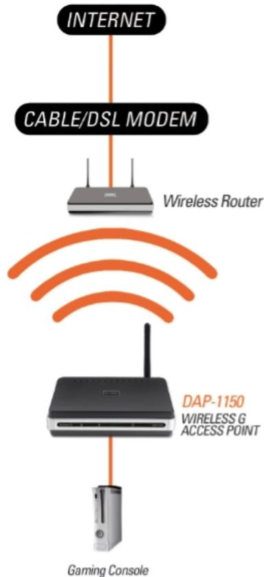
Игровая консоль с портом Ethernet использует DAP-1150 в качестве беспроводного интерфейса для подключения к Интернет
