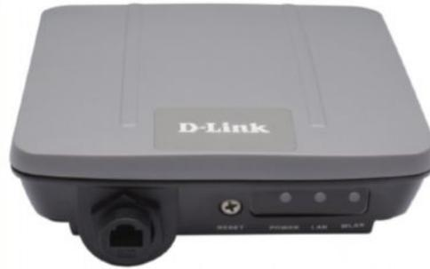
Мощная и надежная внешняя точка доступа D-Link DAP-3220 предназначена для сетей масштаба предприятия и предлагает богатый набор функций для построения управляемых и защищенных беспроводных локальных сетей. Точка доступа поддерживает стандарт Power over Ethernet (PoE).
