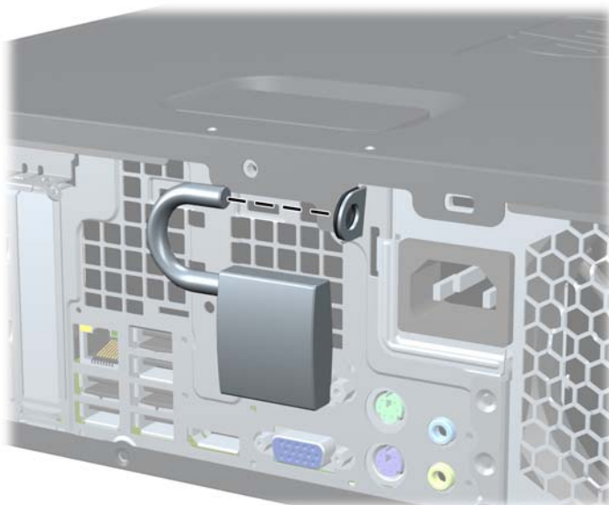
Рисунок 50 Установка навесного замка
