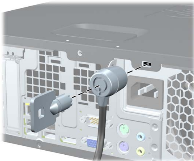
Рисунок 49 Установка замка с тросиком
