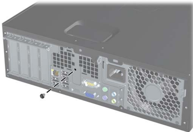
Рисунок 1 Снятие винта блокировки крышки
