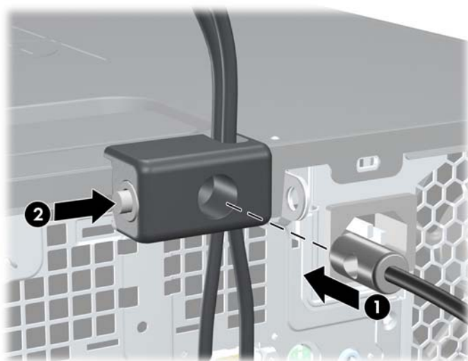
Рисунок 54 Закрытие блокировочного устройства
