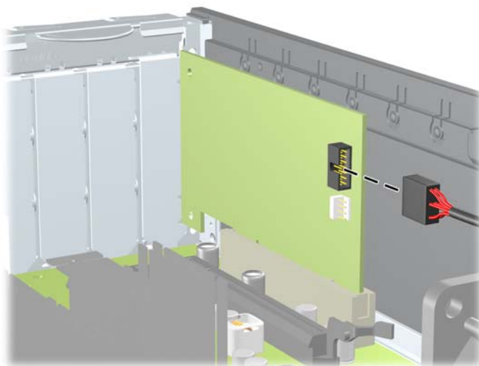
Рисунок 29 Отсоединение кабеля 1394 устройства чтения карт памяти
