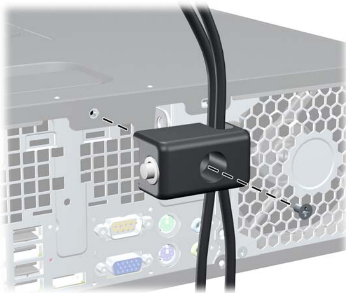
Рисунок 53 Прикрепление блокировочного устройства к корпусу
