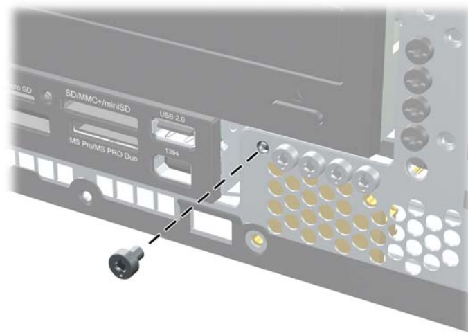
Рисунок 55 Поиск блокировочного винта передней панели
