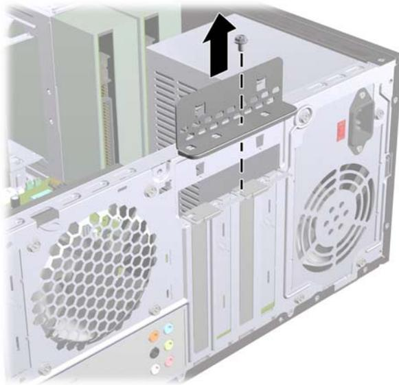
8. Перед установкой новой платы расширения следует удалить заглушку гнезда или извлечь имеющуюся в этом гнезде старую плату расширения.
