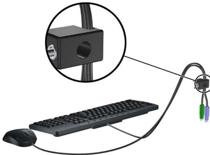
3. Прикрепите блокировочное устройство к корпусу с помощью прилагаемых винтов.
