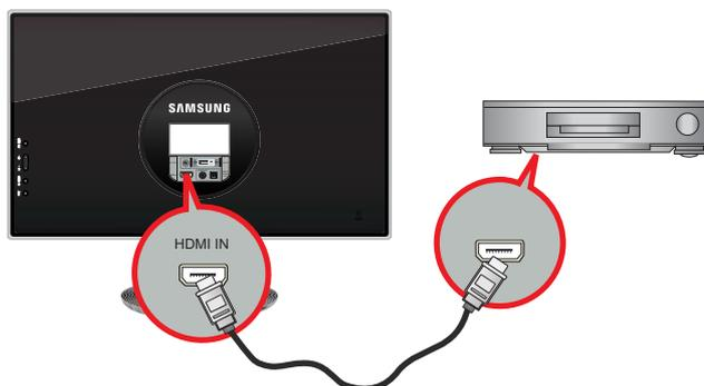
2. С помощью кабеля DVI подсоедините выходной порт HDMI цифрового устройства вывода к порту [HDMI IN] устройства.
