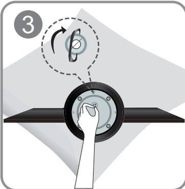
Полностью закрутите соединительный винт в нижней части подставки, чтобы как следует зафиксировать соединительный элемент.
