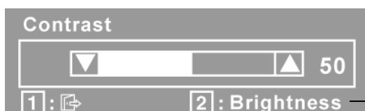
Строка в нижней части экрана предлагает дальнейшие действия: выход из меню или выбор регулировки яркости.
