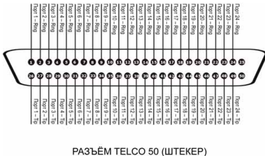
Рис. 57 Назначение контактов в разъёме кабеля Telco-50
