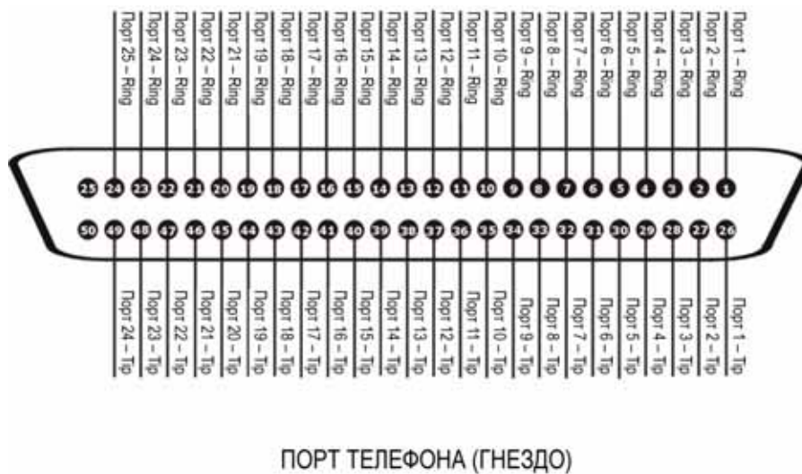
Рис. 56 Назначение контактов порта Telco-50
