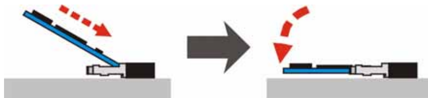
Рис. 3 Установка модуля DSP
